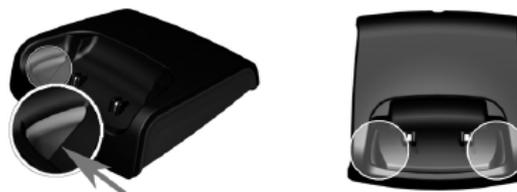
Alternativ können Sie die Kunststoffführungen entfernen, indem Sie mit einem Schraubendreher in die Schlitzlöcher an der Unterseite der Ladeschale drücken.
